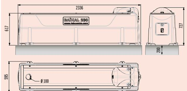
Il est indispensable d'installer le BAÏKAL 230 sur un socle béton d'une hauteur minimale de 20 cm.
